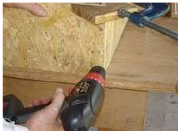
Depois monte as paredes externas correspondentes, colando-as nas paredes de dentro e parafusando-as.
