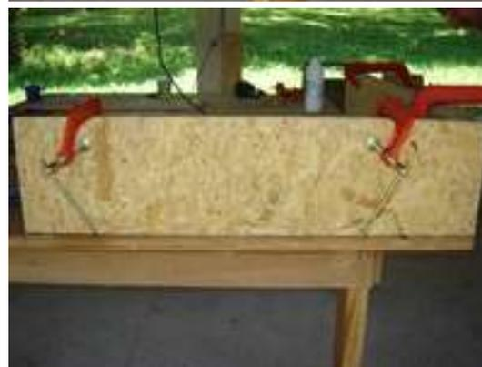
Cole e parafuse a última parede interna e a última parede externa da mesma forma.
