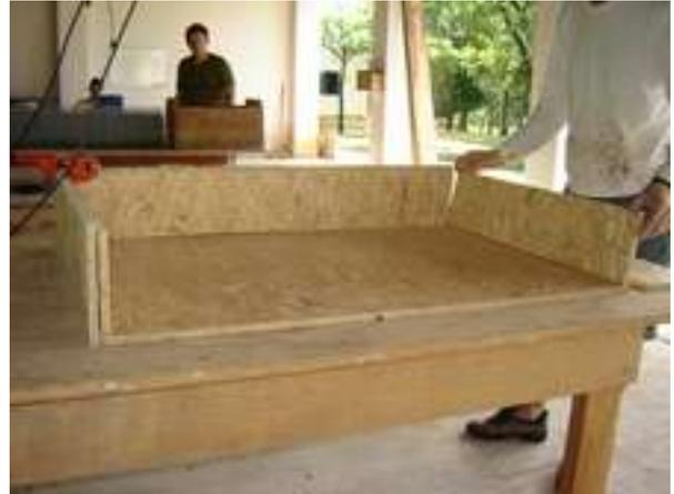
Você pode utilizar uma peça de madeira cortada como na figura ao lado para fixar as laterais com a ajuda de um sargento
