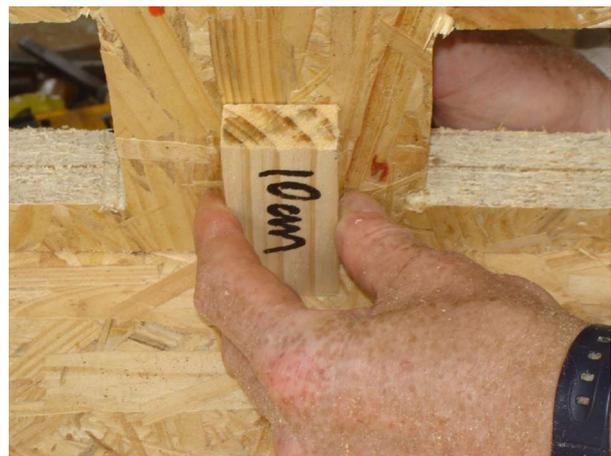
Passe a barra rosqueada pela peça de 10 cm, pela parede do secador e pela peça de 5 cm. Fixe com porca e arruela. Corte a barra rosqueada no tamanho suficiente.
